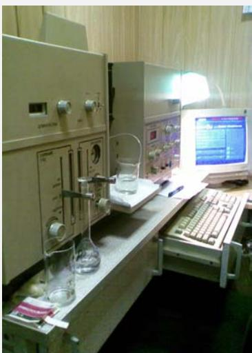
**Атомно-абсорбционный спектрометр с пламенной атомизацией «КВАНТ ЭФА»
